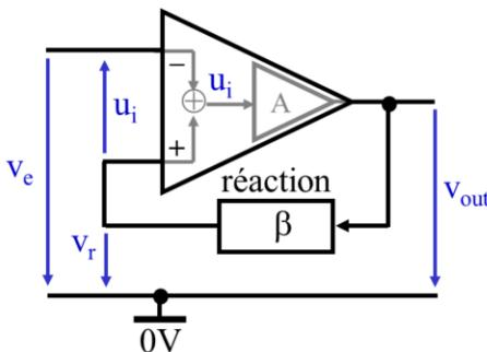
Le système n'a pas d'état d'équilibre; il diverge vers la saturation positive ou négative suivant que  $u_i = v_r - v_e$  est positive ou négative.
