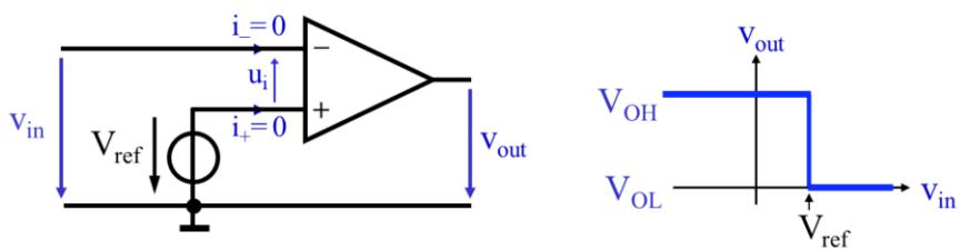
Pour effectuer une comparaison, il est donc préférable d'utiliser un circuit dédié dit "comparateur", plutôt qu'un ampli op
