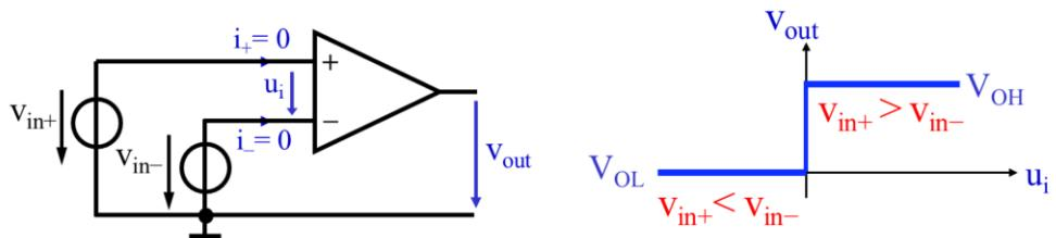
Un amplificateur opérationnel peut parfois remplacer un comparateur, mais un comparateur ne peut pas fonctionner en réaction négative comme un ampli op.
