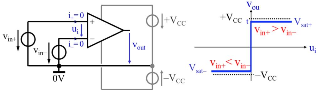
**En l'absence de réaction négative, l'amplificateur opérationnel fonctionne en comparateur simple.**
